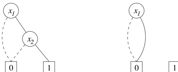
Abbildung 13: OBDDs für f(x_1, x_2) = x_1x_2 und f_{|x_2=0}
